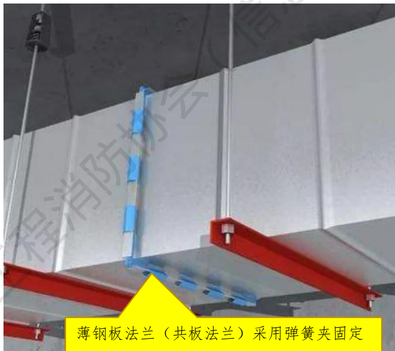
图 2.7.9-1 薄钢板法兰（共板法兰）未使用螺栓连接示意图
